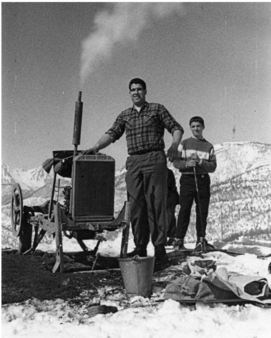
Passo delle Radici, 16 marzo 1958. Il capitano alpino Carlo Vardi di Castelnuovo, mentre collauda un impianto sciistico di risalita di sua invenzione realizzato con un motore Balilla 3 marce con la collaborazione dell'esperto meccanico Edilio Ferrando. La foto è stata gentilmente concessa dall'amico Rodolfo De Cesari.
